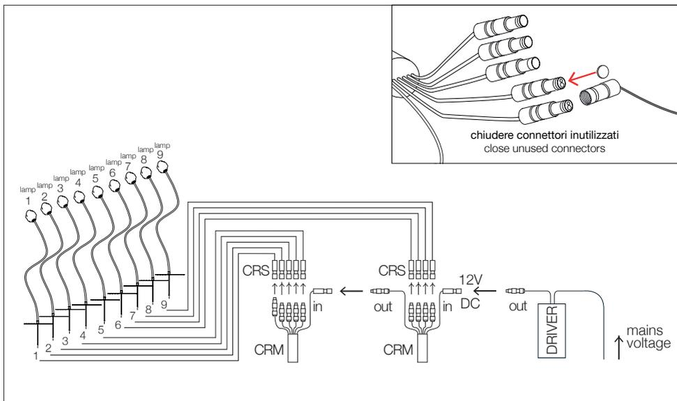
**montaggio e sostituzione lampadina / bulb mounting and replacement**
